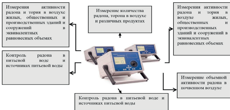
Рис.2. Измерительный комплекс “Альфарад”
